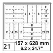
Das Paneel (1) ist in der hinteren Raumecke zu platzieren. Vorher wird die Nutlippe einer kurzen und einer langen Seite abgebrochen, welche zu beiden Raumbegrenzungen (Wänden) zeigen. Zwischen den Wänden und dem Laminatfußboden sind ca. 12 mm Randabstand mittels Abstandskeilen einzuhalten.
