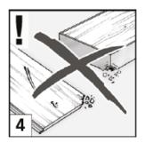
Überprüfen Sie die einzelnen Dielen vor dem Verlegen bitte nochmals auf Schäden, Maße und optische Gleichheit der Oberfläche bei Tageslicht am Verlegeort. Bei verarbeiteten Paneelen können Sie keine Reklamationsansprüche mehr geltend machen.
