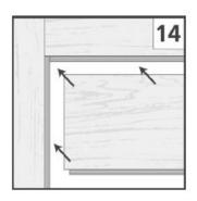
Es muss nach jedem Herstellen einer Federseite sichergestellt werden, dass diese mit der Nutseite des vorhergehenden Paneels zu verbinden ist, beispielsweise durch unverklebtes Aneinanderhalten der beiden Paneele zueinander.
